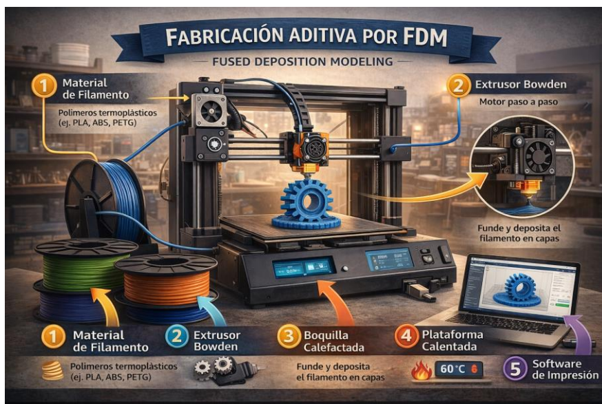
Figura 2. Ilustración esquemática de los componentes esenciales de una impresora 3D estándar
