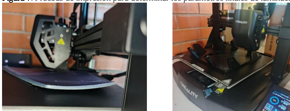
Figura 7. Pruebas de impresión para determinar los parámetros finales de laminación del filamento
